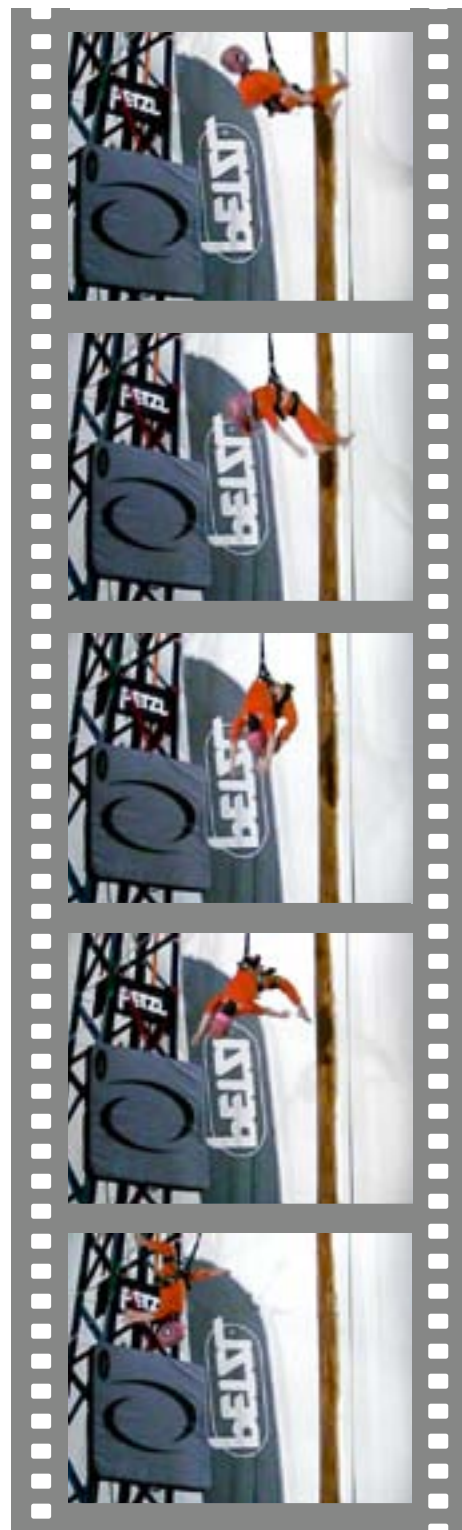
Le film de l'essai de chute normalisée d'un mannequin de 15 kg a démontré que le système de freinage des sets de via ferrata ne fonctionne pas, ce qui engendre une force de choc extrêmement brutale pouvant occasionner des blessures mortelles.
