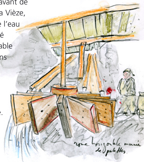
Une des très rares roues hydrauliques horizontales du Valais aux Moulins de la Tine.
